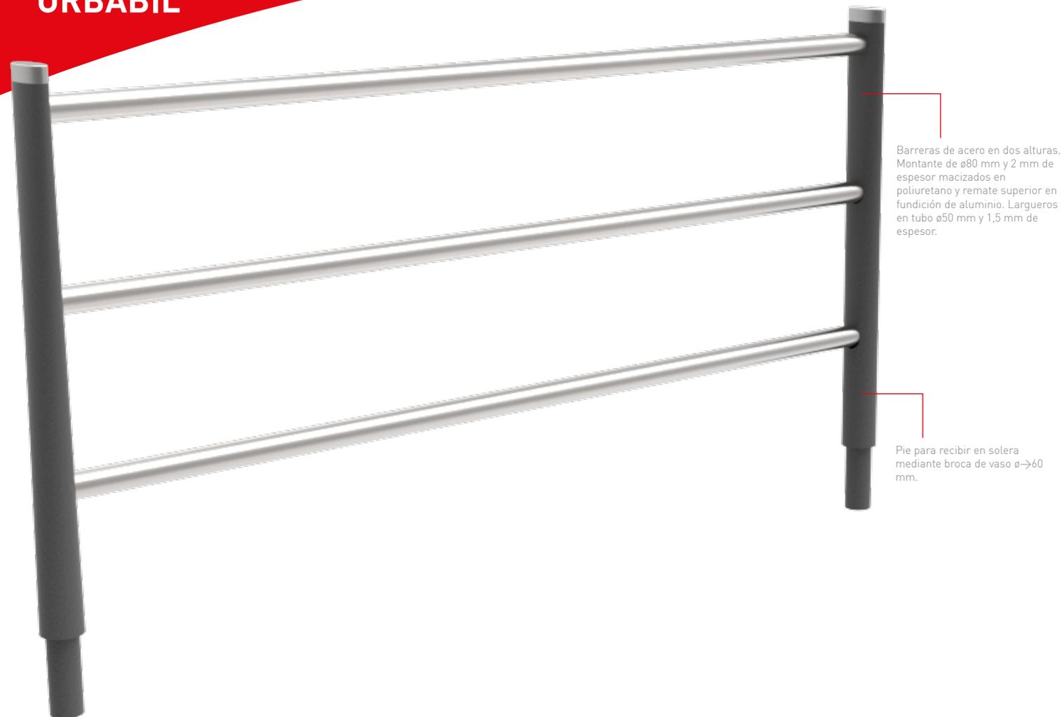
Barreras de acero en dos alturas. Montante de  $\varnothing 80$  mm y 2 mm de espesor macizados en poliuretano y remate superior en fundición de aluminio. Largueros en tubo  $\varnothing 50$  mm y 1,5 mm de espesor.
