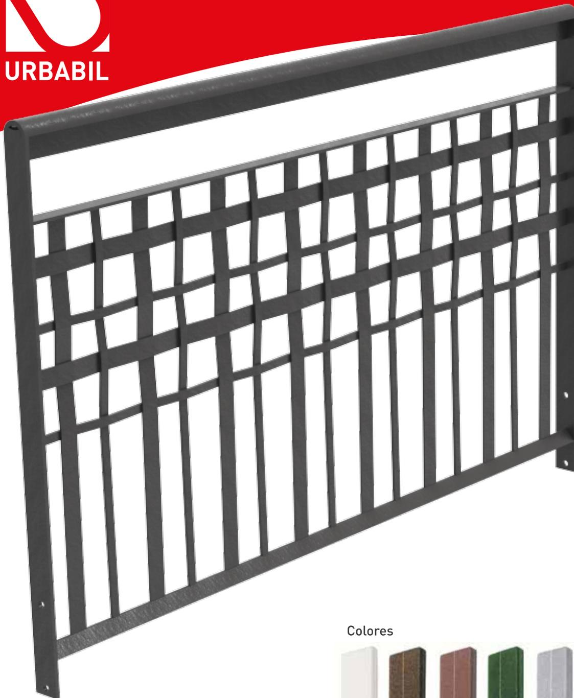
Pasamanos integrado de alta resistencia. Perfil macizo, media caña de laminación en caliente de 8mm de espesor, reforzado con costilla maciza de 60 x 5 mm. Soporta grandes cargas sin deformarse, no se oxida por condensación y no presenta soldaduras a la vista.
